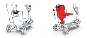
11. 從包裝中取出電池,然後放入ATTO踏板左前側的空電池槽中;先插入 電池的後部,然後向後滑動到底後輕輕向下推,直到聽到喀噠聲為止。
