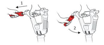
握住駕駛控制台並打開側邊調節桿到底,將駕駛控制台輕輕向下推到底, 關上調節桿。
